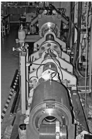
図-3 二段式軽ガス銃：口径 20 mm、最高速度 4 km/s
